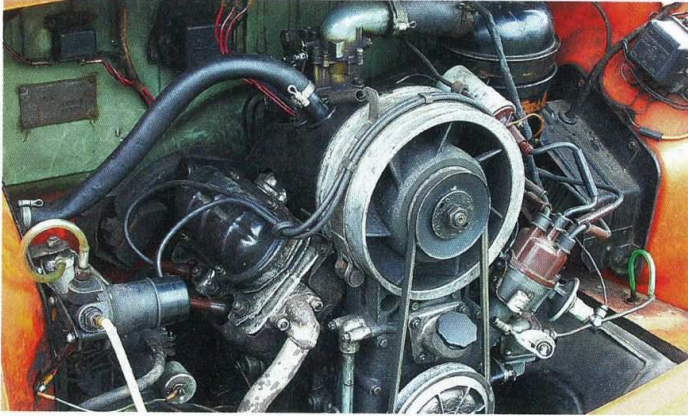
Mythen ranken sich um den knapp 900 Kubik großen V-Vierzylinder, der einst als Anlasser für sowjetische Panzer gedient haben soll
