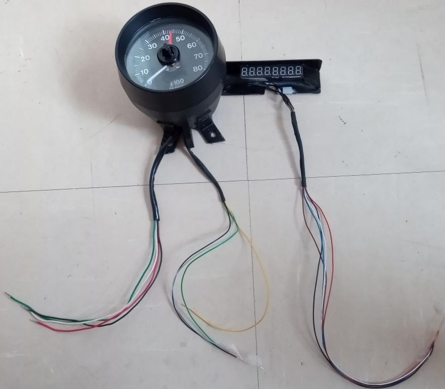
10 bis 16 Volt Bordspannung
