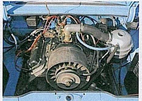
Der 40-PS-Motor ist kurzhubig (Bohrung x Hub: 76 x 66 Millimeter) und niedrig verdichtet
