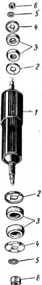
Bild 44. Hinterer Stoßdämpfer
